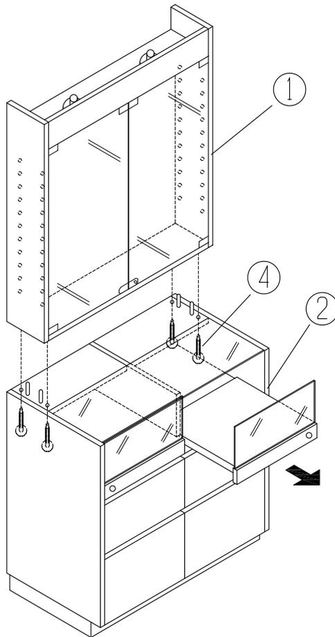
上台①裏面の穴に下台②のダボが入るように上台①を下台②に乗せます。
