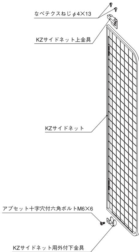
1. KZ 柱の下側の角孔に外付下金具を回転させて入れます。
